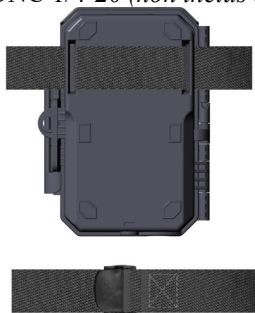
Figure 17: Montage de la caméra
