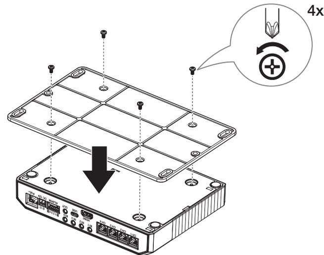
2. Bringen Sie die Haupteinheit mit der Montagehalterung und den entsprechenden Schrauben an der Wand an.
