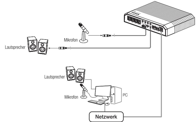
1. Verbinden Sie den AUDIO IN-Anschluss der Haupteinheit mit dem Mikrofon oder dem LINE OUT-Anschluss des Verstärkers, an den das Mikrofon angeschlossen ist.
