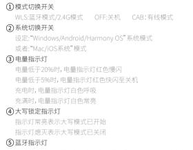
⑤ 蓝牙指示灯 启动蓝牙配对时,蓝牙指示灯呈慢闪状态(3min),配对成功后常亮 回连设备时,指示灯呈快闪状态(1min),回连成功后常亮 ⑥2.4G指示灯 启动2.4G配对时, 2.4G指示灯程慢闪状态 (1min), 配对成功后常亮
