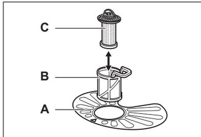
1. Drehen Sie den Filter (B) gegen den Uhrzeigersinn und nehmen Sie ihn heraus.
