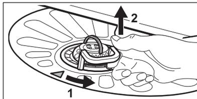
2. Entfernen Sie den Filter (C) aus dem Filter (B).
