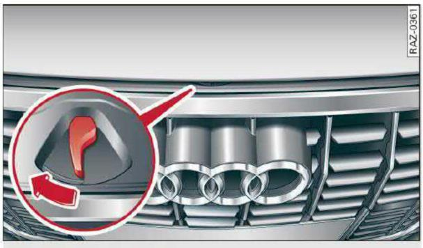
Fig. 158 Unlocked hood: lever
