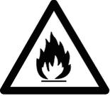
DANGER - Risque d'incendie ou d'explosion. Réfrigérant inflammable utilisé. Les réparations ne peuvent être effectuées que par du personnel de service formé. Ne percez pas les lignes de réfrigérant.
