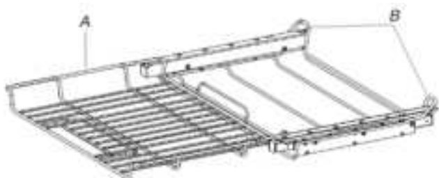
A. Grille coulissante SatinGlide™ déployante pour accessoires de four intelligent B. Support coulissant
