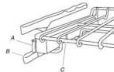
A. Support coulissant B. Guide de grille C. Grille coulissante déployante SatinGlide™
