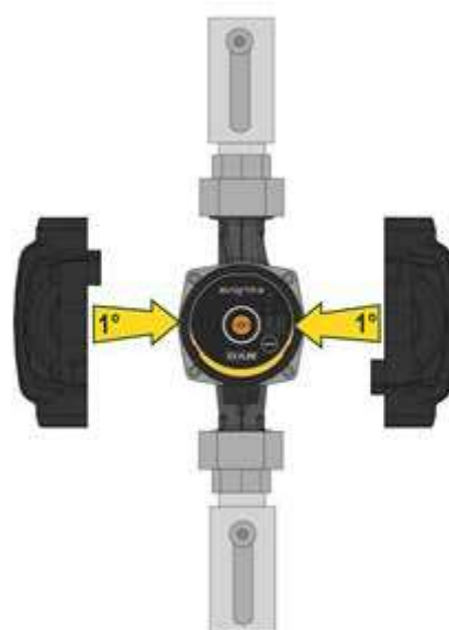
Figura 6: Izolare corp pompa
