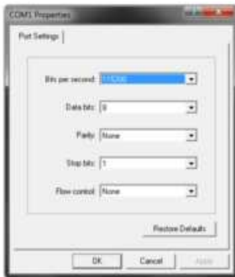
Рисунок 5 — Параметры настройки COM-порта
