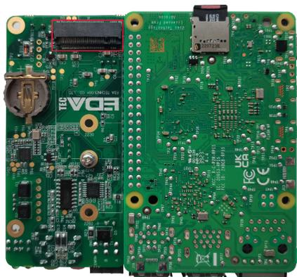
2. 使用螺丝刀逆时针拧下固定SSD的螺钉。
