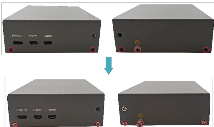
4. 使PCBA上的接口对准前面板的接口位置，插入前盖板，再使用螺丝刀顺时针拧紧2颗M3螺钉。
