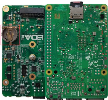
2. 将电池正极朝上，按压装进RTC底座中，安装完成的效果如下图。
