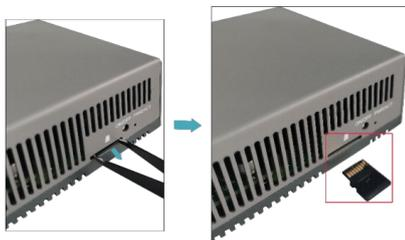
3. 将取下来的SD卡插入读卡器,然后插入电脑的USB接口。
