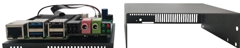
6. 使用螺丝刀逆时针拧下6颗PCBA安装螺钉，拆除下盖板。
