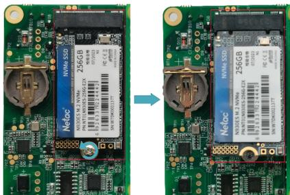
3. 用手握住SSD的两侧，沿着箭头方向往外拔出。
