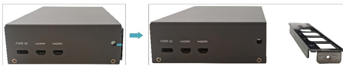
4. 使用螺丝刀逆时针拧下2个侧面的4颗M2.5螺钉和1颗接地螺钉，如下图红色标记处。
