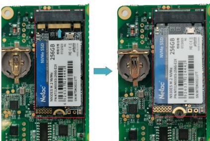
4. 插入固定SSD的螺钉，顺时针拧紧将SSD固定在PCBA上。
