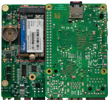
2. 使用螺丝刀逆时针拧下固定SSD的螺钉。
