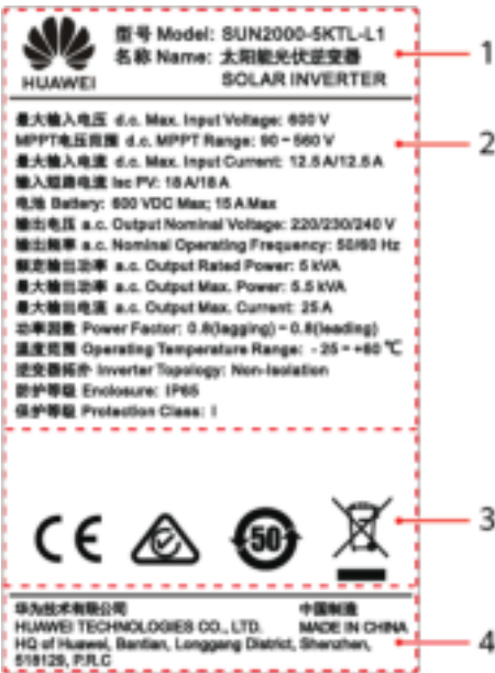
Figura 2-6 Placa de identificación (SUN2000-5KTL-L1 como ejemplo)
