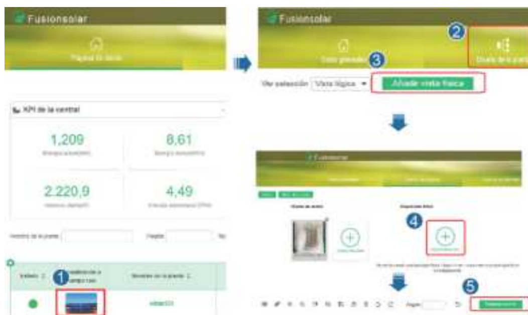
Figura 7-7 Diseño físico de los módulos fotovoltaicos
