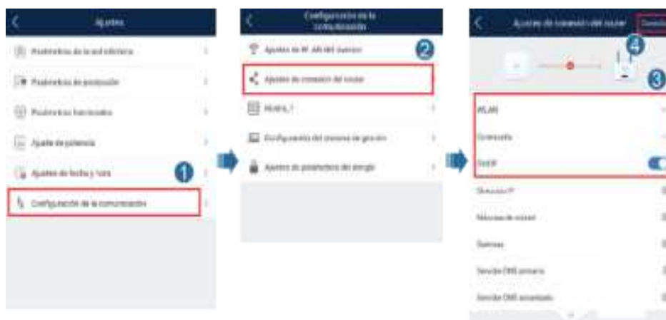
Figura C-2 Configuración de los parámetros del router
