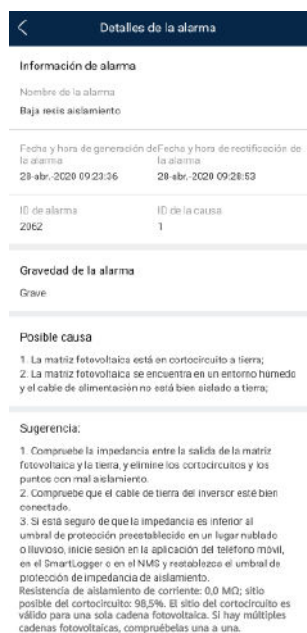
Figura E-1 Detalles de alarma
