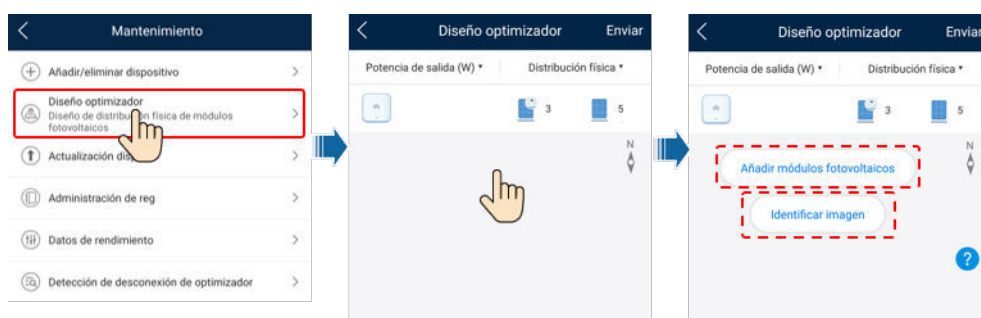
Figura 7-8 Diseño físico de los módulos fotovoltaicos
