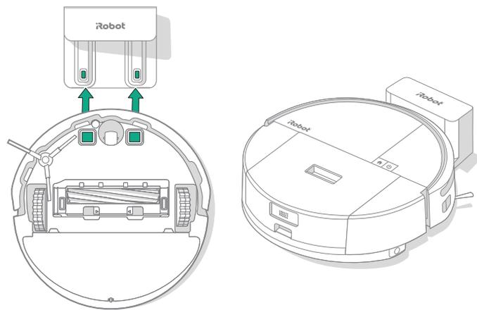
Posiziona il robot davanti alla stazione, poi fallo scorrere verso di essa, allineando i contatti metallici di ricarica. Dopo alcuni minuti un segnale acustico ti informerà che il robot è attivo.
