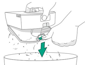
**2** Rimuovi il serbatoio dell'acqua e il panno premendo i pulsanti di sblocco del serbatoio su entrambi i lati del robot per estrarlo.
