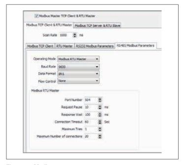
Figure 66. Modbus parameters
