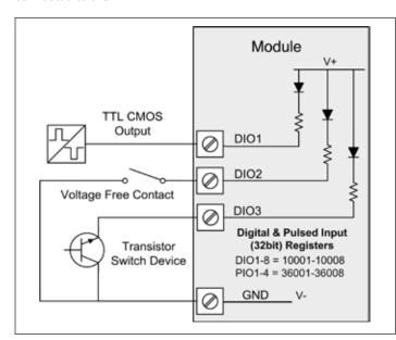
Figure 15. Digital/pulsed input wiring
