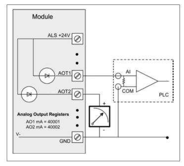
Figure 23. Analog outputs
