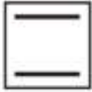
Włączony dolny i górny element
