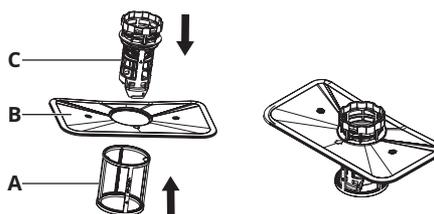
5. Insérez l'ensemble de filtres en position et tournez-le dans le sens des aiguilles d'une montre jusqu'à ce qu'il soit verrouillé. Assurez-vous que les flèches sur le filtre (B) et (C) sont alignées, comme indiqué sur la figure ci-dessous.
