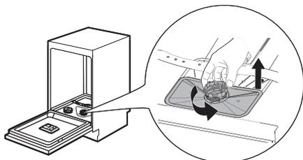
2. Retirez d'abord le filtre (A) de l'ensemble en le comprimant délicatement. Les filtres (B) et (C) peuvent ensuite être détachés.
