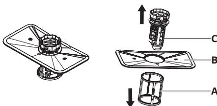
3. Rincez les filtres (A), (B) et (C) avec de l'eau. Si nécessaire, utilisez une brosse de nettoyage douce.
