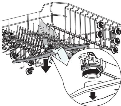
3. Pour détacher le bras inférieur du bas de l'appareil, il suffit de le tirer vers le haut pour le retirer.
