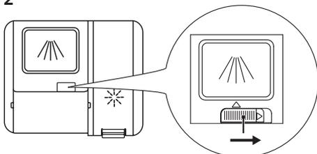
Faites glisser le loquet de déverrouillage vers la droite, puis ouvrez le couvercle du distributeur de détergent
