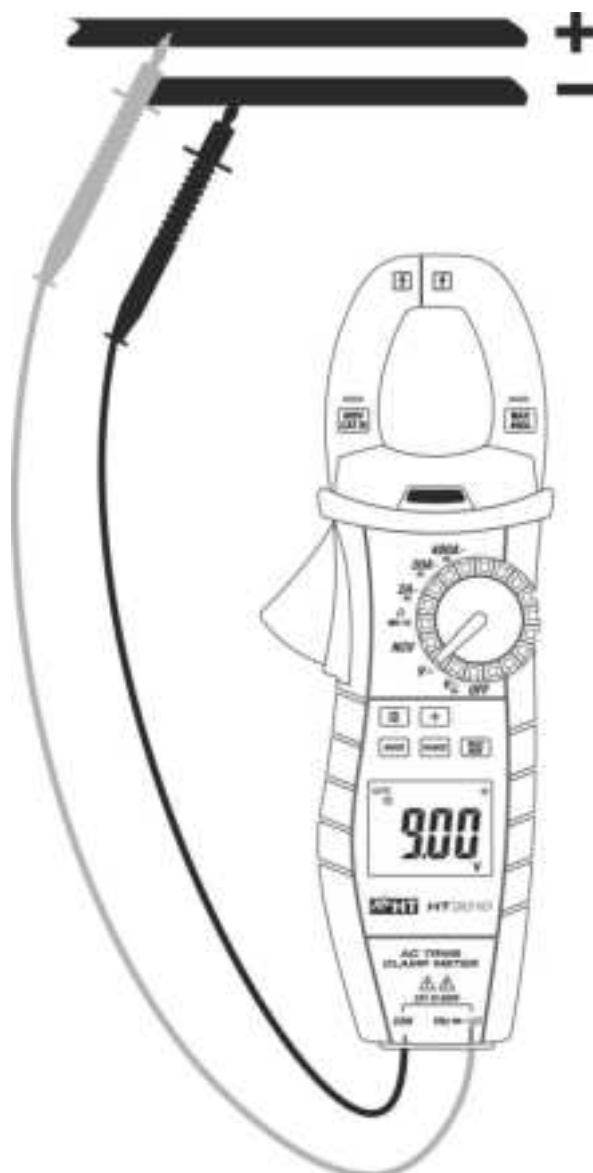
Fig. 3 : Utilisation de l'instrument pour mesure de Tension CC
