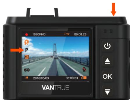
Wenn die Kamera im Parkmodus eine Bewegung erkennt, beginnt sie automatisch mit der Aufnahme. und wenn die Bewegung stoppt, wird die Aufnahme nach 10 Sekunden beendet.
