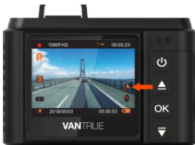
5. Sie können das GPS und die Geschwindigkeit auf das Videomaterial stempeln, gehen Sie zu "Video Einstellung">"Stempel">"Geschwindigkeit Stempel", "GPSStempel" zu setzen.
