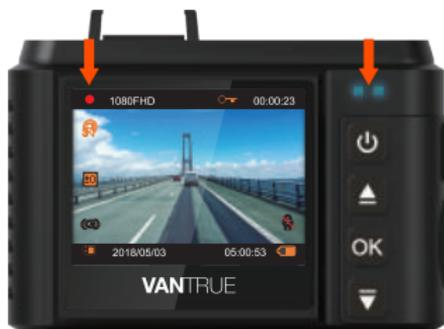
Standardmäßig ist die Loop-Aufnahmezeit 3 Minuten. Bitte gehen Sie zu "Video Einstellung">"Zirkulationsaufnahme", um auf 1 Minute, 3 Minuten oder 5 Minuten für Ihren Bedarf zu wechseln. Wenn es ausgeschaltet wird, nimmt die Kamera Videos in 30 Minuten pro Clip auf, aber würde die alten Videos nicht überschreiben, wenn die Karte voll ist.
