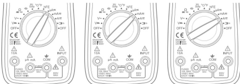
3. 電流タイプを選択します。「セレクト」ボタンを押してDCまたはAC電流テストのいずれかを選択します。
