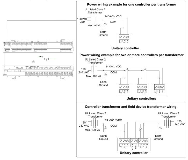
$_{\triangle}$  WHEN CONNECTING POWER TO THE UNITARY CONTROLLERS, CONNECT THE COM OF THE VAC SECONDARY CIRCUIT TO A KNOWN EARTH GROUND.
