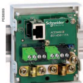
Interfaccia di collegamento rete RS 485 2 fili ACE949-2.
