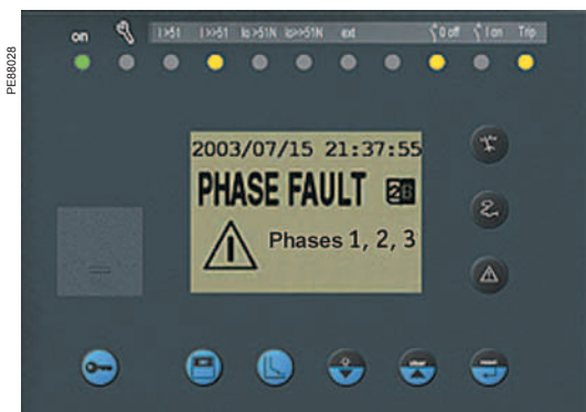
Indicazioni LED sul pannello frontale del Sepam.
