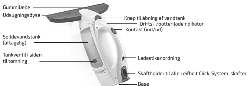
Figur 2: Vinduestørrerens betjeningsselementer
