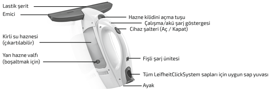
Şekil 2: Cam temizleme cihazının kontrol elemanları
