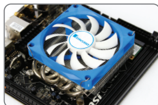
6 Secure the cooler to Motherboard with HEX nuts, EVA washer should be in between. Befestigen Sie den Kühler mit HEX-Muttern am Motherboard. Die EVA-Unterlegscheibe sollte dazwischen liegen. Fixez le refroidisseur à la carte mère à l'aide d'écrous HEX. La rondelle EVA doit être entre les deux. 用HEX螺母将散热器固定在主板上，EVA垫圈应介于两者之间。
