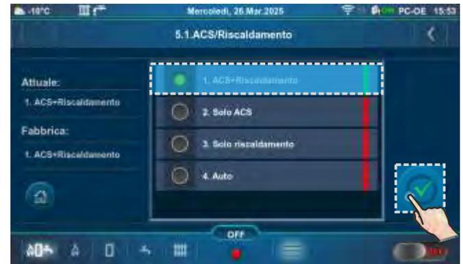
**ACS+Riscaldamento** - la caldaia funziona in base alle esigenze per il riscaldamento o per l'acqua calda sanitaria (ACS).
