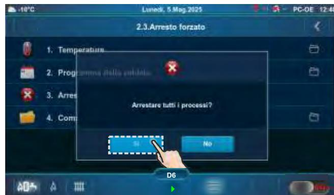
**ATTENZIONE! Se volete fare l'arresto di tutti i processi, bisogna prima spegnere la caldaia nel solito modo passando da ON
