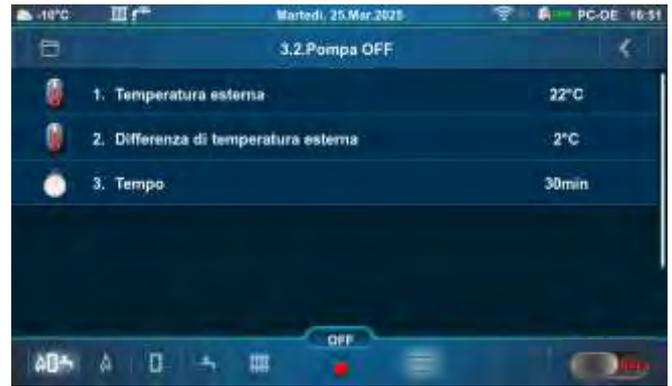
Configurazione: 1, 2, 3, 6, 7, 14, 15, 18, 19, 21, 22, 23, 24, 25, 26, 27, 28, 29, 30, 31, 32, 33, 34, 35, 36, 37, 38, 39, 40, 41, 42 - se la temperatura esterna misurata è superiore alla temperatura esterna impostata + differenza di temperatura esterna impostata per la durata del tempo impostato, la pompa del circuito di riscaldamento viene spenta.
