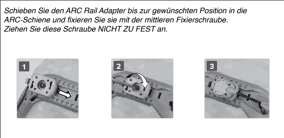
Abbildung 4 – Installation der ARC-Schiene
