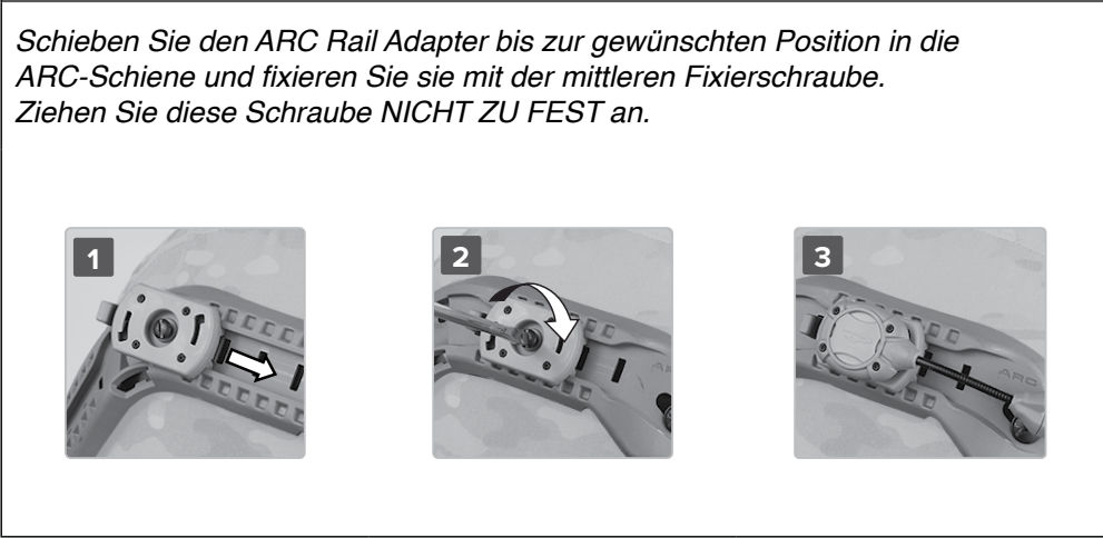
Abbildung 4 – Installation der ARC-Schiene
