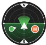
Quando le icone del drone e del radiocomando diventano entrambe verdi, indica che il telecomando è rivolto verso il drone, il che garantisce un segnale di comunicazione ottimale.
