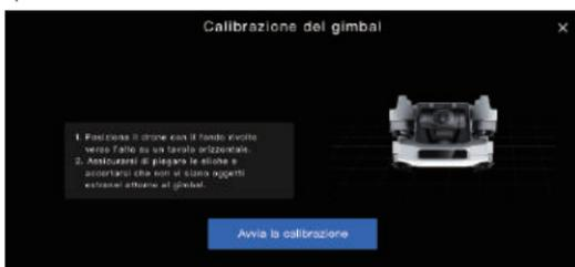
**⚠ Non spostare il drone in modo significativo durante il processo di calibrazione, altrimenti la calibrazione potrebbe fallire.**
