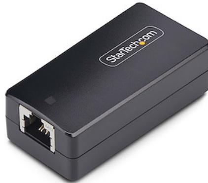
Questo isolatore di rete da 1G, conforme TAA con isolamento fino a 4kV è alimentato dal bus e crea una separazione galvanica di tutti i circuiti elettrici collegati tramite un cavo Ethernet. L'isolatore aiuta a prevenire le dispersioni di terra nelle apparecchiature audio e video collegate.
