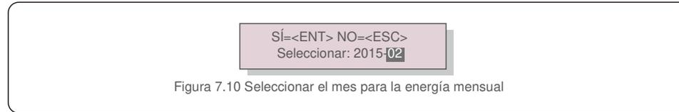
Presione la tecla ABAJO para mover el cursor al día y mes; presione la tecla ARRIBA para cambiar el dígito. Presione INTRO después de fijar la fecha.
