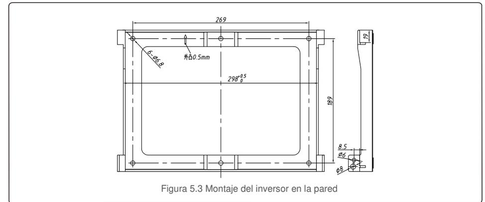
Figura 5.3 Montaje del inversor en la pared
