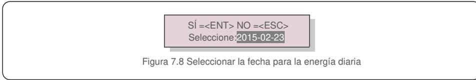
Presione la tecla ABAJO para mover el cursor al día, mes y año; presione la tecla ARRIBA para cambiar el dígito. Presione INTRO después de fijar la fecha.
