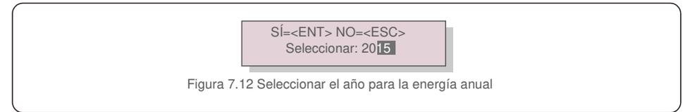
Presione la tecla ABAJO para mover el cursor al día y año; presione la tecla ARRIBA para cambiar el dígito. Presione INTRO después de fijar la fecha.
