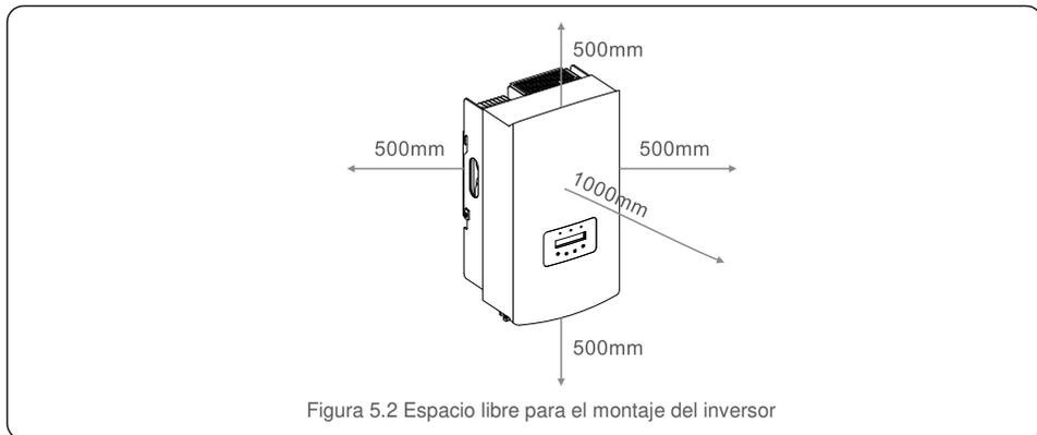
Figura 5.2 Espacio libre para el montaje del inversor
