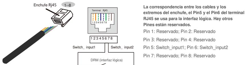
Figura 5.31 Pele la capa de aislamiento y conéctela al enchufe RJ45
