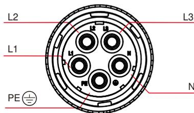
Figura 5.21 Estructura interna del conector de CA
