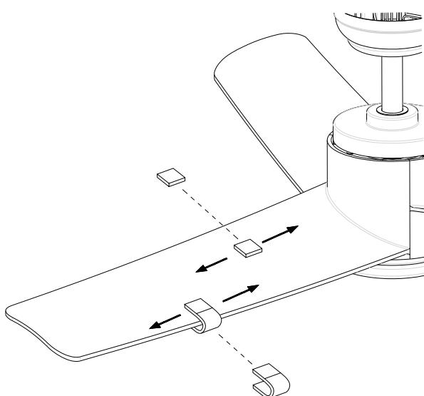
Zapnite ventilátor a nastavte rýchlosť (zvyčajne vysokú rýchlosť), ktorá spôsobuje najhoršie kmitanie.
