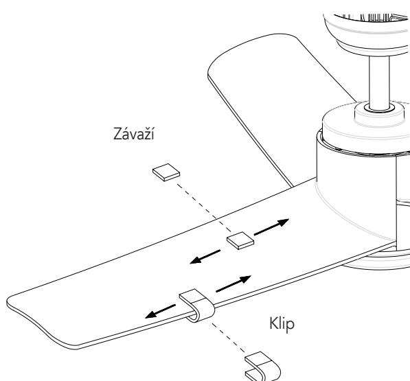
Zapněte ventilátor a nastavte rychlosť (obvykle vysokou), která způsobuje nejhorší kmitání. Vypněte ventilátor, vyberte jednu lopatku a nasadte na ni využovací klip. Ventilátor znova zapněte a sledujte, zda se oscilace zlepšila nebo zhoršila.
