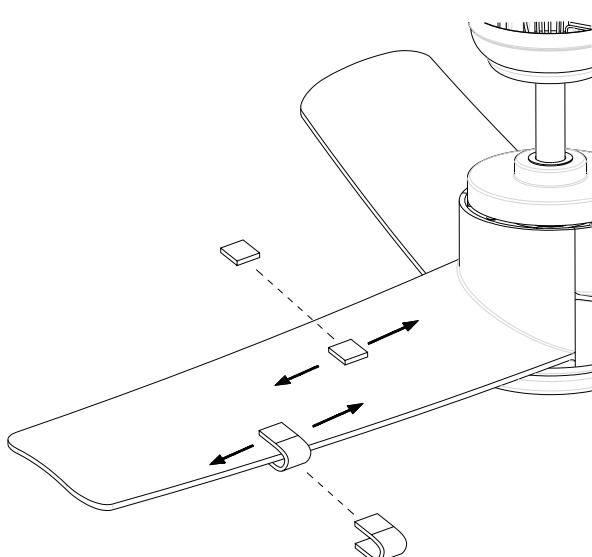
Porniți ventilatorul și setați viteza (de obicei, viteza mare) care provoacă cea mai gravă oscilație. Opriti ventilatorul. Îndepărtați o lamă și puneți pe ea o clema de echilibrare. Porniți din nou ventilatorul și observați dacă oscilația s-a îmbunătățit sau s-a înrăutățit.
