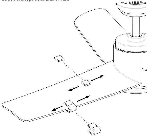
Porniți ventilatorul și setați viteza (de obicei, viteza mare) care provoacă cea mai gravă oscilație. Opritii ventilatorul. Îndepărtați o lamă și puneti pe ea o clema de echilibrare. Porniți din nou ventilatorul și observați dacă oscilația s-a îmbunătățit sau s-a înrăutățit.
