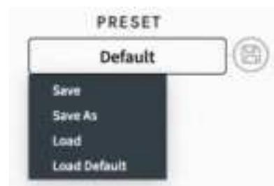
La fonction Preset de Polar Control vous permet de sauvegarder et de charger des configurations de mixage, ce qui vous permet de passer rapidement d'une configuration à l'autre en fonction de vos besoins en matière d'enregistrement ou de mixage.
