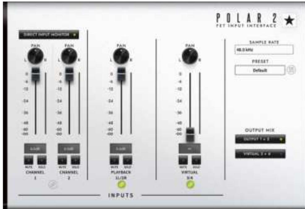
1. **Stereo Link (lien stéréo)** : Relie deux canaux entre eux, ce qui leur permet d'être contrôlés simultanément pour un fonctionnement stéréo.
