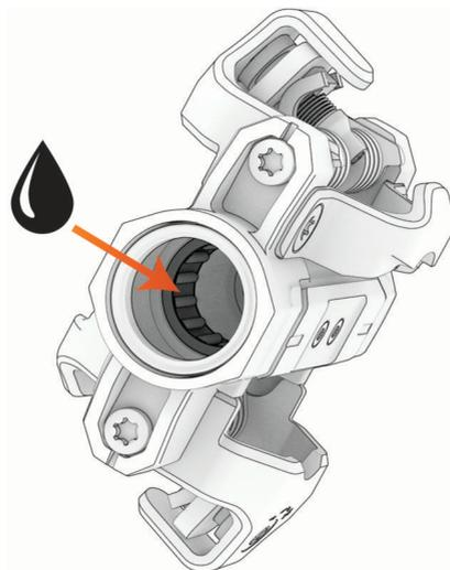
6 Applicare un sottile strato di lubrificante sulle aree evidenziate del nuovo mandrino.
