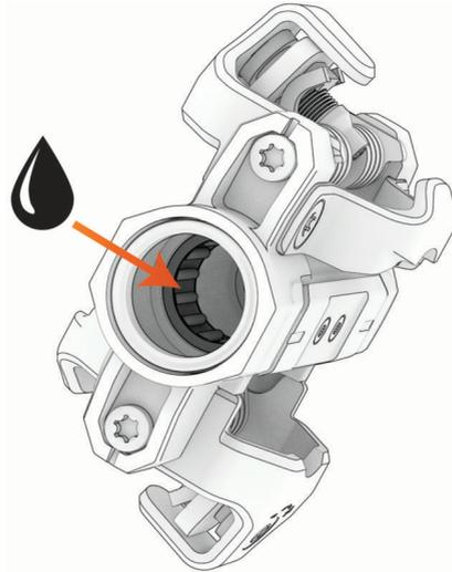
7 Inserire il mandrino nel nuovo corpo del pedale e ruotarlo alcune volte per distribuire il lubrificante.
