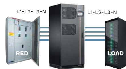
instalación de 4 conductores (L1-L2-L3-N)
