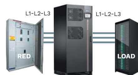
instalación de 3 conductores (L1-L2-L3)
