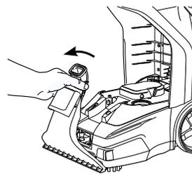
2 Tire ligeramente hacia arriba de la boquilla para descajarla y, a continuación, tire de la boquilla hacia delante para retirarla del limpiador de alfombras. Enjuague con agua y deje secar completamente.
