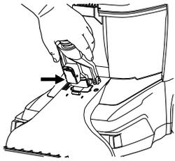
1 Presione el botón y tire firmemente hacia arriba para quitar el tubo de la solución de la manguera del puerto de solución.
