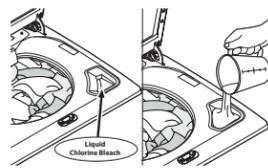
Ajouter une mesure d'agent de blanchiment liquide au chlore dans la tasse distributrice. Ne pas remplir excessivement le distributeur, diluer le produit ou utiliser plus d'une tasse (236 mL). Ne pas utiliser d'agent de blanchiment sans danger pour les couleurs ni de produit Oxi avec un programme utilisant de l'eau de Javel.
