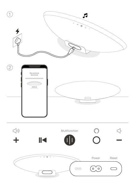
Multifunction - Multifonction / Multifunktionstaste / Multifunción / Multifunzione / 多功能的 / 多機能 Power - Secteur / Netzeingang / Alimentación / Presa alimentazione / 电源 / 電源 Reset - Réinitialisation / Reset / Reinicialización / Ripristino / 重启 / リセット
