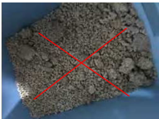
Agglomération de granulés de mauvaise qualité
