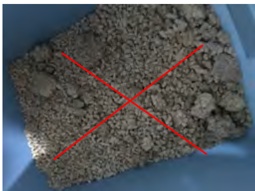
Agglomération de granulés de mauvaise qualité
