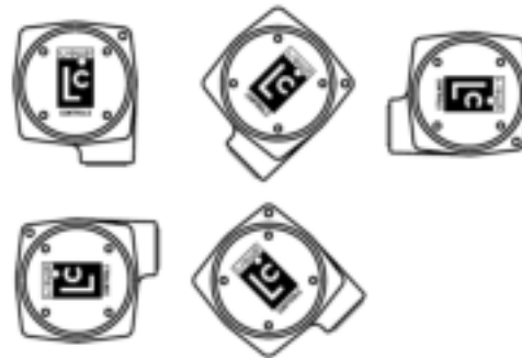
Recommended POD Conduit Hub Orientations
