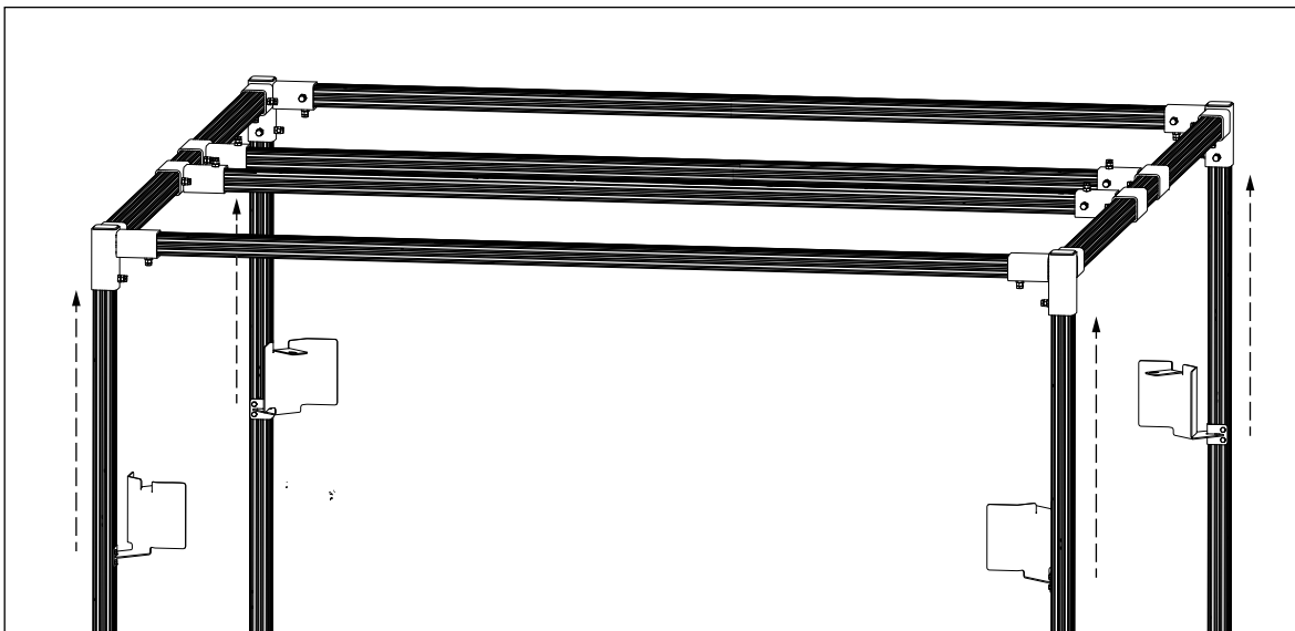
Figura 3-14. Fijación del conjunto del sensor IFM remoto
