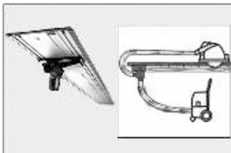
Fig. 38: Utilizar el sistema Aerofix para cortes de separación
