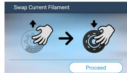
5. ノズルが動作温度に上昇しましたら、フィラメントをフィーダーに挿入します。
