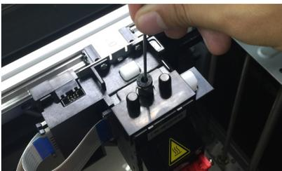
② ブラシを使用し、ノズル先端部に残る材料を除去します。
