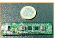
In dieser Schaltung wird ein sogenannte analoge Mikrocontroller ADuC7060/ADuC7061 (sogenannt, weil er neben einem ARM-Rechenkern unter anderem zwei 24-Bit-A/D-Wandler „on Board“ hat) eingesetzt. In dieser Applikation zur präzisen Temperaturüberwachung mit einem Thermoelement und einem Pt100. Letzterer wird für die Kaltstellen-Kompensation verwendet.
