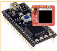
mbed baut auf einem 32-bittigen Cortex-M3 Controller von NXP auf und arbeitet dennoch wunderbar mit Hardware zusammen, die für Atmels 8-Bit Architektur AVR konzipiert wurde. Möglich wurde dies durch die Definition eines Standards für Erweiterungshardware des Arduino-Projektes. Wenn dann noch vorgefertigte Softwarebibliotheken für die Anwendungsentwicklung zur Verfügung stehen, muss eigentlich nur noch parametrisiert werden.
