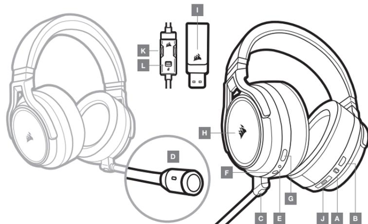
**A** — Селекторный переключатель режима беспроводной/проводной связи
