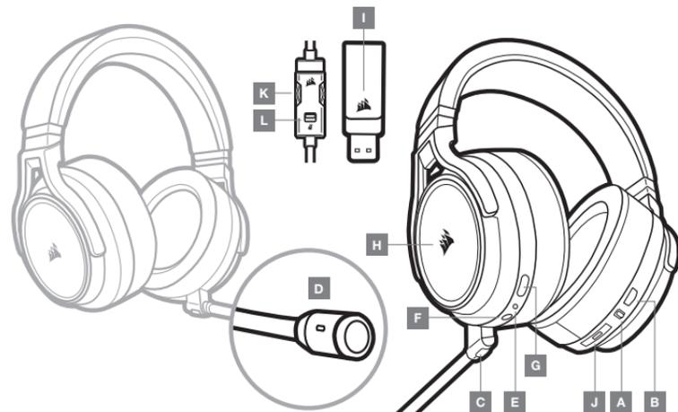
**A** — Selettore della modalità di funzionamento wireless/via cavo
