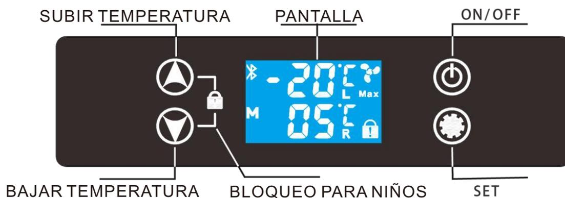
Rango de control de temperatura:  $-20-20^{\circ}\text{C}$  ( $-4-68^{\circ}\text{F}$ )
