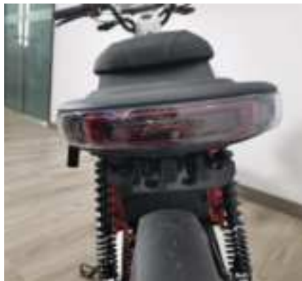
Figura 13. Fars de frenada i llums de direcció posteriors
