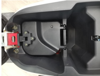
Figura 16. Pestanya tapa protectora de la bateria
