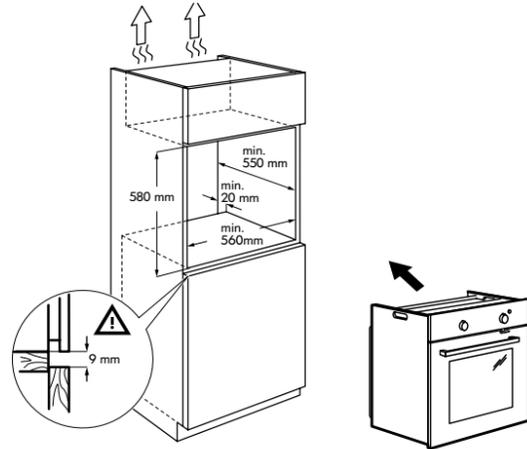
Modèle : four dans un caisson bas
