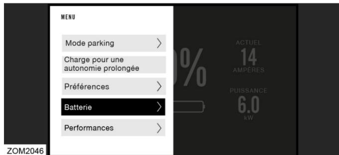
La sélection de l'option Batterie ouvre le menu Batterie et permet au motard d'afficher le statut de la batterie et de modifier la Cible de charge.
