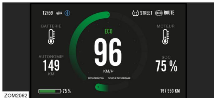
L'écran de conduite est affiché quand le contacteur à clé est en position ON et que la moto est prête à rouler (avec l'interrupteur d'arrêt du moteur en position ON et la béquille relevée (rétractée)).
