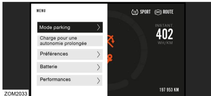
L'écran de menu s'affiche pour pouvoir régler les préférences à propos des éléments qui s'affichent sur l'écran de conduite, vérifier le statut de la batterie, vérifier le statut de performance et vérifier le statut du compteur kilométrique et du trajet.
