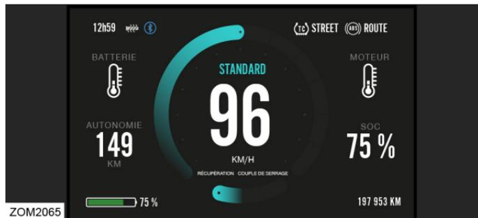
La sélection **STANDARD** maintient l'accélération et le freinage par régénération à un compromis confortable pour une utilisation quotidienne. Le couple et la puissance sont supérieurs au mode ECO mais inférieurs au mode SPORT. Le freinage par régénération est supérieur au mode RAIN mais inférieur aux modes ECO et SPORT. L'écran de conduite **STANDARD** présente une couleur accentuée bleue clair.
