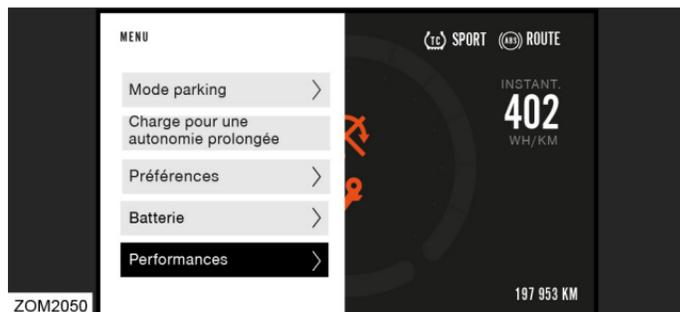
La sélection de l'option Performance ouvre le menu Interface de performance, où la fonctionnalité ABS peut être activée (**On**) ou désactivée (**Off**).
