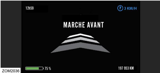
Si nécessaire, appuyez sur le bouton du régulateur de vitesse pour passer en mode Marche avant.
