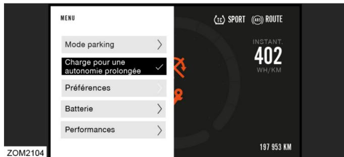
Activez la charge pour une autonomie prolongée par l'intermédiaire de l'écran du menu principal en appuyant sur le bouton MODE et en mettant en surbrillance **Charge pour une autonomie prolongée**. Appuyez sur le bouton MODE ; une coche apparaîtra.
