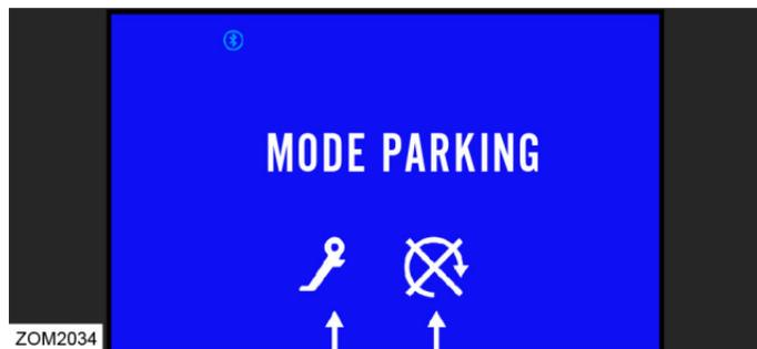
Une fois le mode parking sélectionné, le tableau de bord affiche l'écran principal du mode parking. Les flèches sous l'interrupteur d'arrêt du moteur et les icônes de la béquille clignoteront. Relevez la béquille et mettez l'interrupteur d'arrêt du moteur sur la position ON.
