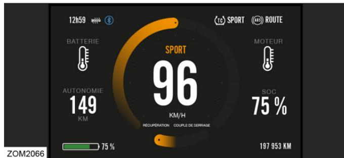
La sélection **SPORT** permet à la moto d'accélérer à un rythme nettement plus rapide que les autres modes. Par rapport à ECO, la quantité de régénération est réduite quand la poignée de l'accélérateur est relâchée. Ce mode est recommandé pour les motards chevronnés. L'écran de conduite **SPORT** présente une couleur accentuée orange clair.
