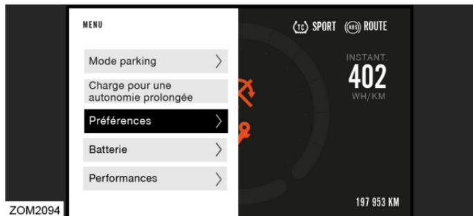
La sélection de l'option Préférences ouvre le menu Interface de conduite et permet au motard de modifier les éléments qui s'affichent sur l'écran de conduite.
