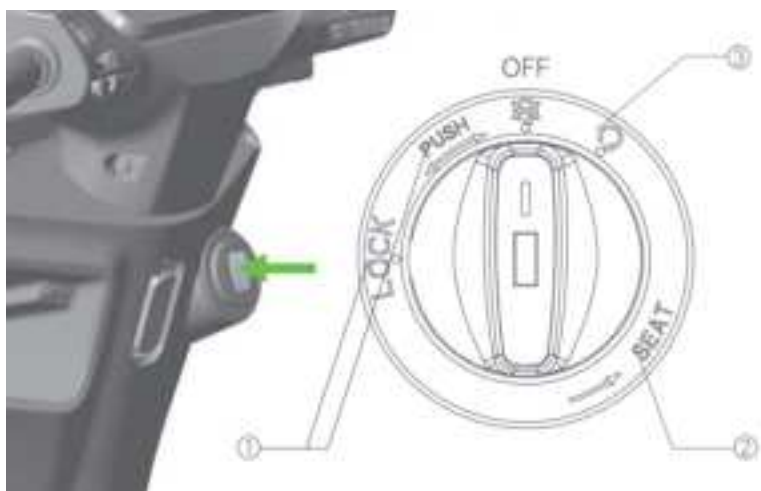
Figura 7. Dispositiu de bloqueig
